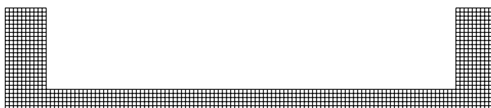
図 9.1.2 解析領域のセル分割図 (軸対称解析 : 1000 セル)
